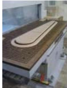
6) La fresadora automática con control numérico permite obtener la forma deseada mediante la combinación de técnicas: agujereando, recortando, puliendo, etc. En cámara insonorizada y estancia con aspiración automática de polvo.
