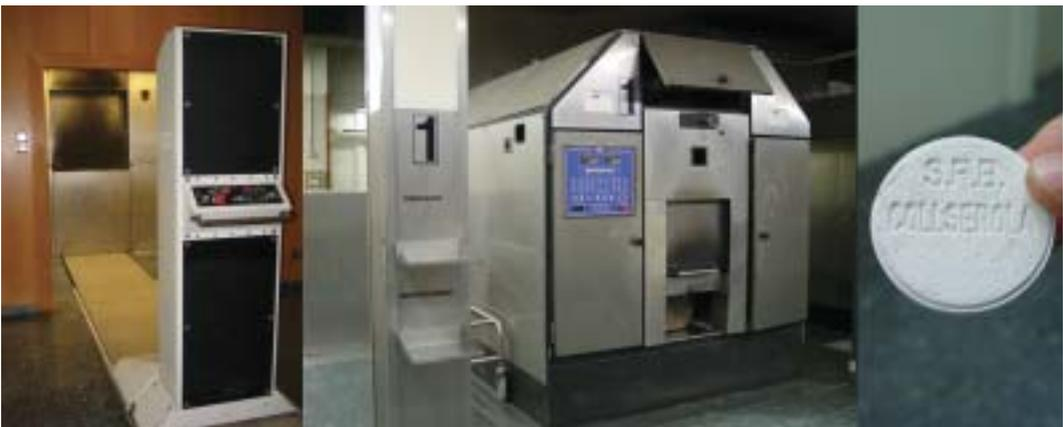
Las instalaciones de los hornos cinerarios permiten en unas dos horas reducir el féretro y el cadáver a unos 3 kg de cenizas. Una pieza de cerámica identifica el cadáver incinerado.
