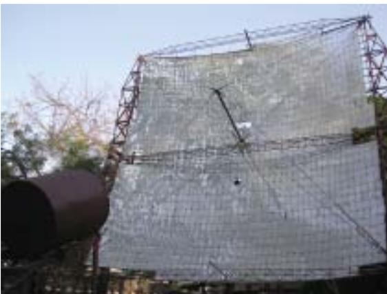
Reflector parabólico desarrollado per Wolfgang Scheffler de 50 m<sup>2</sup> instalado en la India donde se estudia la incineración de cadáveres con energía solar concentrada.
